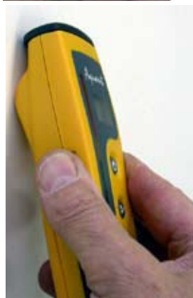
l'instrument est appliqué sur la surface avec un angle de 25°
